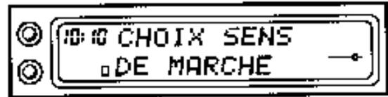
Diese Anzeige erscheint, sobald das Steuergerät in "**verminderte Funktion**" der Fahrtrichtung geht und gleichzeitig die Warnlampe "**Elektronikstörung**"
