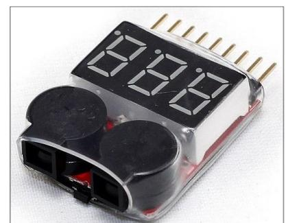
Sie haben den Vorteil, dass sie sehr billig sind ... sie ermöglichen es trotzdem, eine mögliche Anomalie auf einem der Packs zu erkennen.
