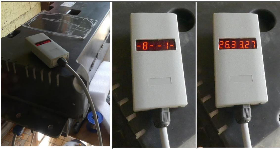
Die Tester sind "Made in China"... Die Idee ist verlockend, aber die Messgenauigkeit ist nicht ausreichend. Ich rate Ihnen daher von ihrer Verwendung ab. Ich werde mir ein anderes Gehäuse mit einem Schaltersystem und zwei Bananensteckern bauen müssen, um ein Voltmeter anzuschließen.
