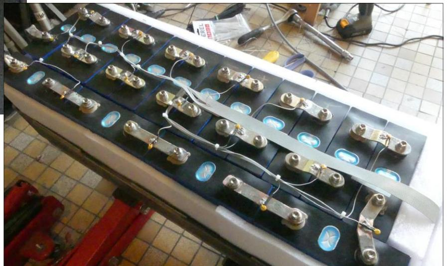
Die Matte ist an einen wasserdichten Industrieverbinder angeschlossen. So kann ich die Spannung jedes einzelnen Moduls leicht messen.
